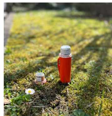
Une fois planté, le géophone (à droite) est presque invisible à la surface (à gauche).
